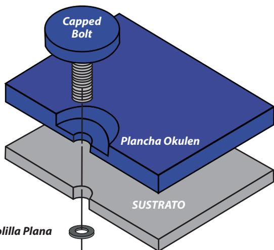
El avellanado y el orificio pasante deben tener el tamaño adecuado para que la aplicación del perno capped bolt sea efectiva.
